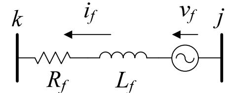
$$v_k - v_j = v_f - R_f i_f - L_f \frac{di_f}{dt}$$
